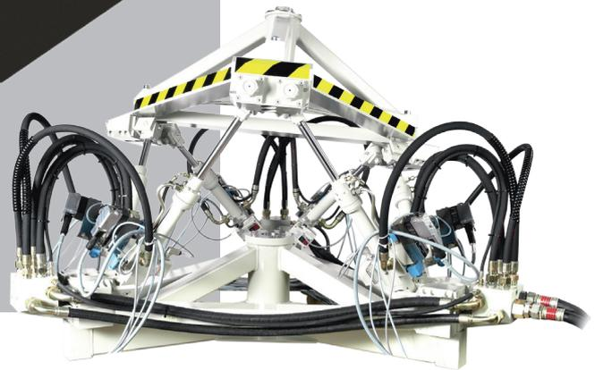
Eine der kritischen Stellen bei Hexapoden sind die Gelenke. Diese sollen möglichst spielfrei sein, hohe Lasten übertragen, keine störenden Reibkräfte und gleichzeitig grosse Winkel ermöglichen. Bei älteren Anlagen wurden dazu oft präzise Wälzlager eingebaut. Nachteil der Wälzkörper ist jedoch, dass sich diese bei hohen Lasten mit der Zeit in die Aussenringe eindrücken. Im Extremfall ent-
